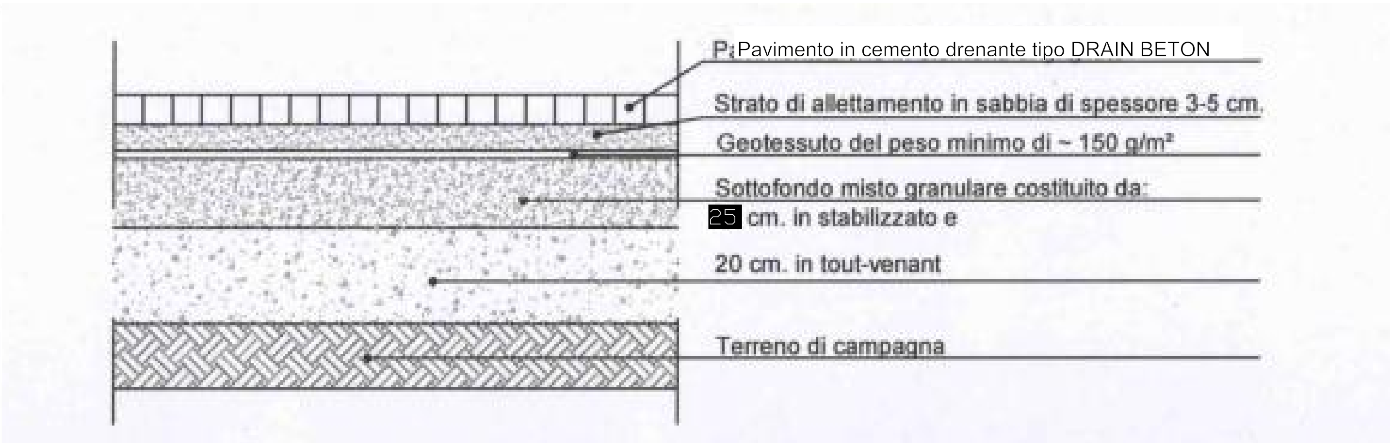
DETTAGLIO COSTRUTTIVO PAVIMENTAZIONE PARCHEGGIO
